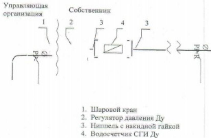
Исполнитель несет ответственность за надлежащее состояние и работоспособность систем горячего и холодного водоснабжения согласно нижеуказанной схеме до волнистой линии слева (включая шаровой кран).
