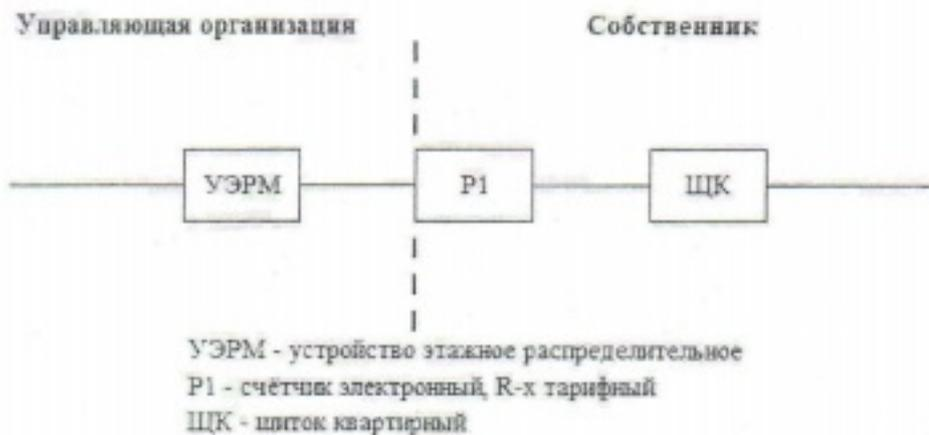
Исполнитель несет ответственность за надлежащее состояние и работоспособность питающих электрических сетей на квартиру согласно нижеуказанной схеме до прибора учета (пунктирной линии слева).
